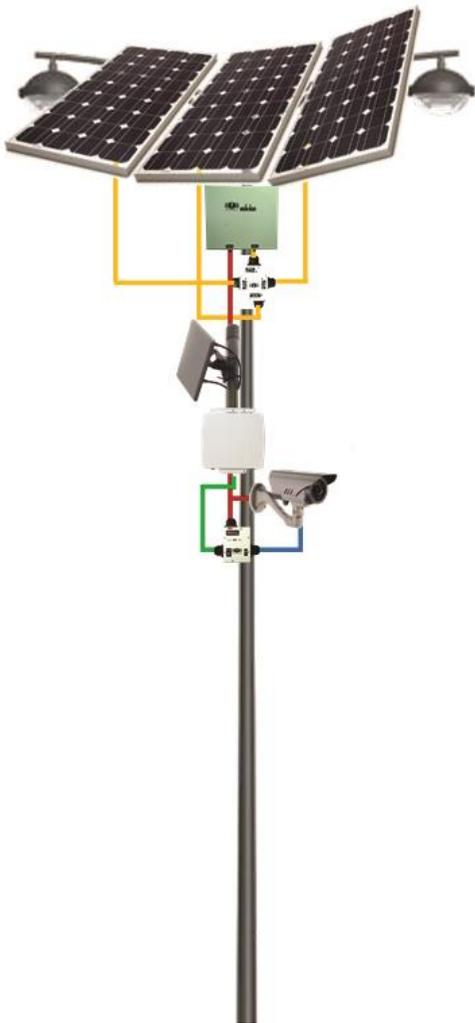
勁電科技 USSS-12V1224-0A 系列是特別針對系統工程商規畫專案系統時，面臨案場無任何可供電的電力系統時，造成專案無法架設系統營運，特別提出太陽能高效集能充放電型供電系統，期望能徹底解決系統工程商在室外工程施工無法取得穩定有效電力問題。
