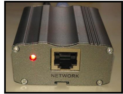
PoE 乙太網路整合器 RJ-45 乙太網路插孔, 連接到操作電腦 (或 LAN 或攝影機或 ADSL 或串接其他無線設備...)
